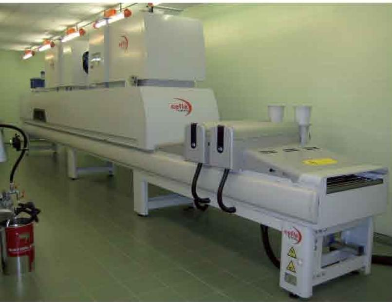
К этой группе относятся полиэфирные или акриловые лакокрасочные материалы, содержащие фотоинициатор. Их сушка происходит немедленно под воздействием ультрафиолетовых лучей, направляемых на поверхность специальными лампами, с использованием или без использования предварительного подогрева.
